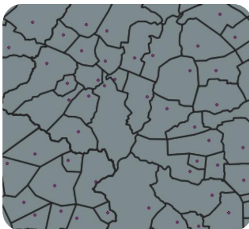
Slika 20 - Primjer MDF-ova i njihovih područja pokrivanja (izvor: Axon na osnovu podataka HT-a)
